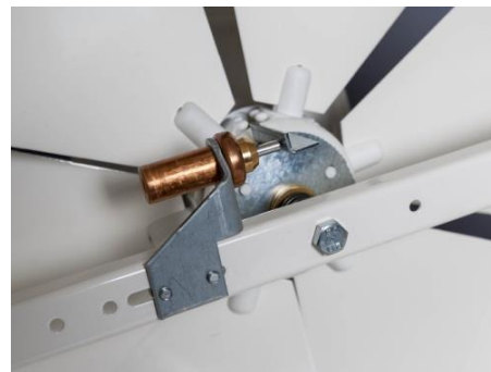
Рух термостатичного приводу в залежності від зміни температури
